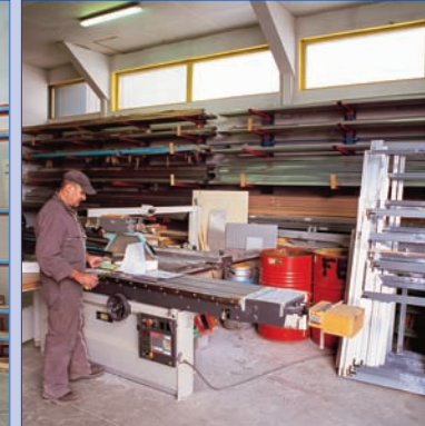
Atelier de débit et d'assemblage des cadres aluminium brut avant thermolaquage.
