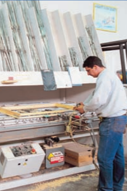
Ferrage des ouvrants sur station de montage semi-automatique.
