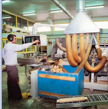
Profilage des pièces de bois sur centre d'usinage numérisé.
