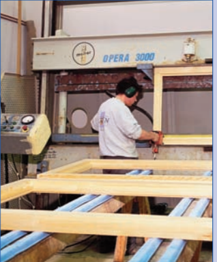
Assemblage des cadres par séchage "haute fréquence" (sans chevilles métalliques).
