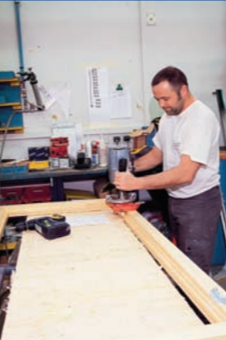
Usinage et équipements des dormants.
