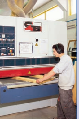
Mise en épaisseur des cadres sur calibreuse tri-bandes.
